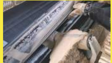
▲ 搬送物の堆積によりローラが不転となりベルトが摩耗
